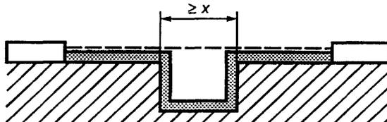
*Условие.* Рассматриваемый путь утечки проходит через желобок с параллельными боковыми стенками любой глубины шириной  $X$  мм или более.
