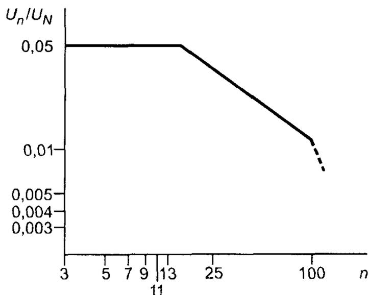
$n$  — порядок гармонической составляющей;  $U_n$  — действующее значение гармоники порядка  $n$ ;  $U_N$  — действующее значение номинального напряжения сети.
