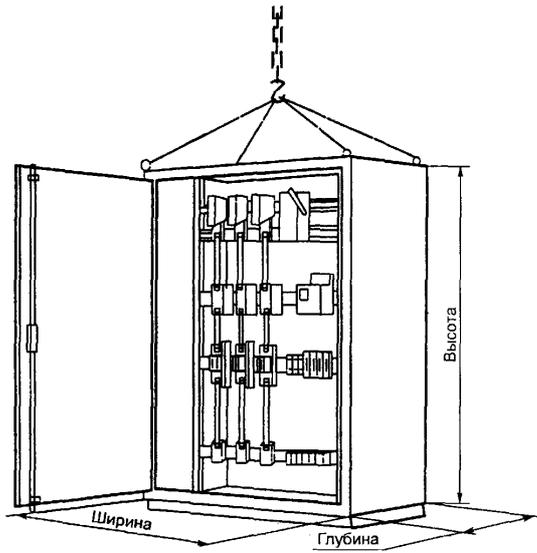
Рисунок С.3 — НКУ заводского изготовления шкафного типа
