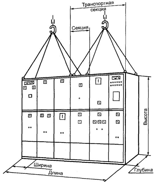
Рисунок С.4 — НКУ заводского изготовления многошкафного типа
