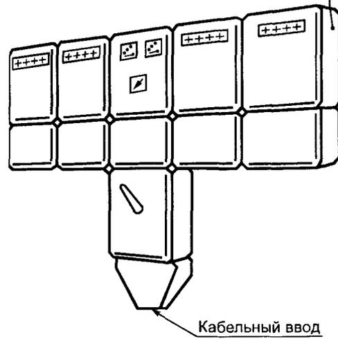
Рисунок С.6 — НКУ заводского изготовления многоящичного типа
