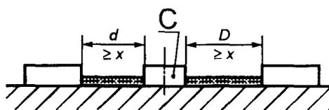
$C$  — свободно движущаяся часть; воздушный зазор равен  $d + D$ ;
